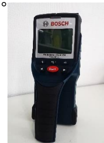
コンクリート探知機
